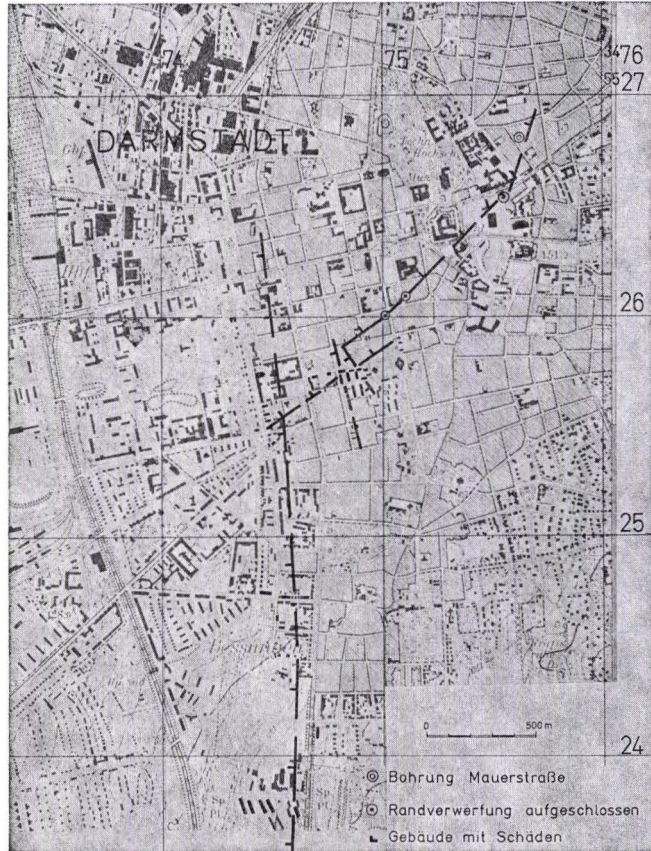
Abb. 1. Der Verlauf des Oberrheingrabenabbruchs in Darmstadt.
