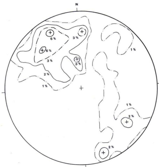
Abb. 10. Gefügediagramm - Störungen Gesamtbereich, 382 Meßwerte, Polpunktdarstellung im Schmidt'schen Netz.
